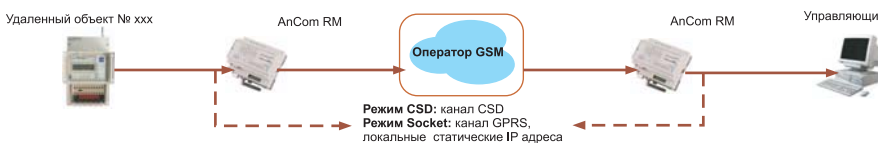
Рис. 10. Организация связи между двумя точками — радиоудлинитель интерфейса
