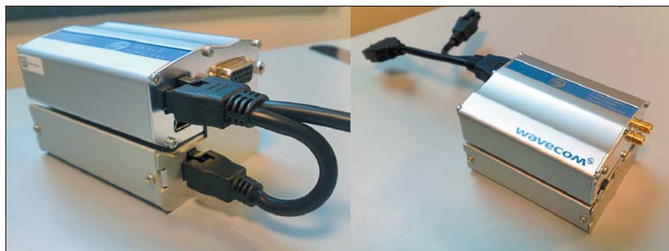
Рис. 2. Вид внешней резервной батареи
