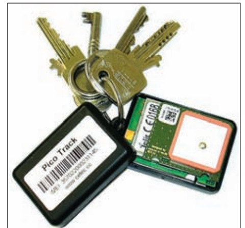
Рис. 2. PicoTrack: устройство позиционирования карманного формата
